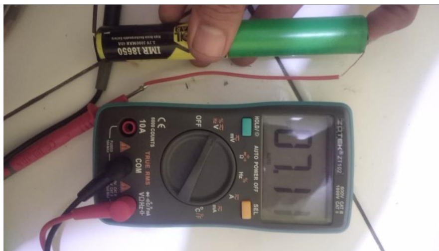
Gambar 15 Pengukuran tegangan pada baterai yang terhubung seri
