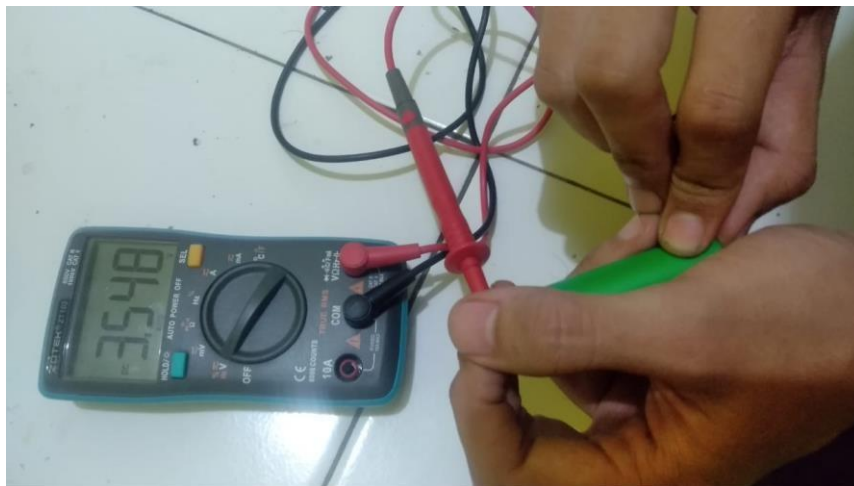
Gambar 14 Pengukuran tegangan pada 1 buah baterai
