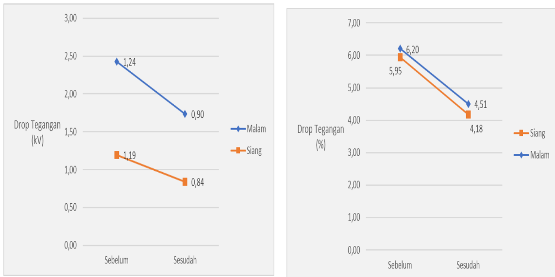
Gambar 15 Perbandingan drop tegangan sebelum dan sesudah dipecah beban
