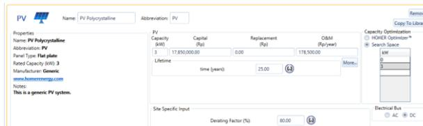
Gambar 6 *Input parameter panel surya*
