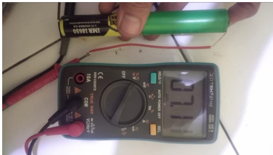
Gambar 15 Pengukuran tegangan pada baterai yang terhubung seri
