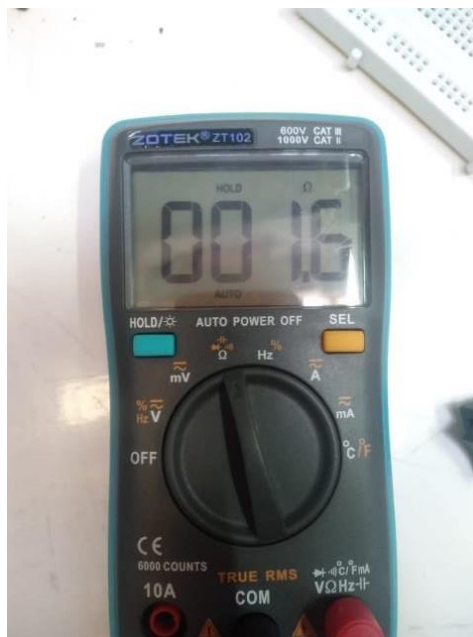
Gambar 13 Hasil pengukuran tahanan diode
