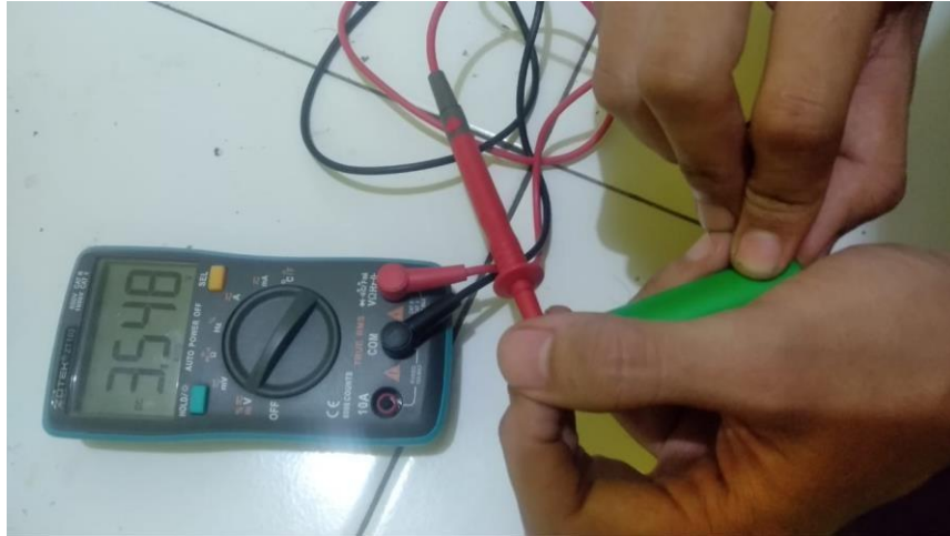
Gambar 14 Pengukuran tegangan pada 1 buah baterai
